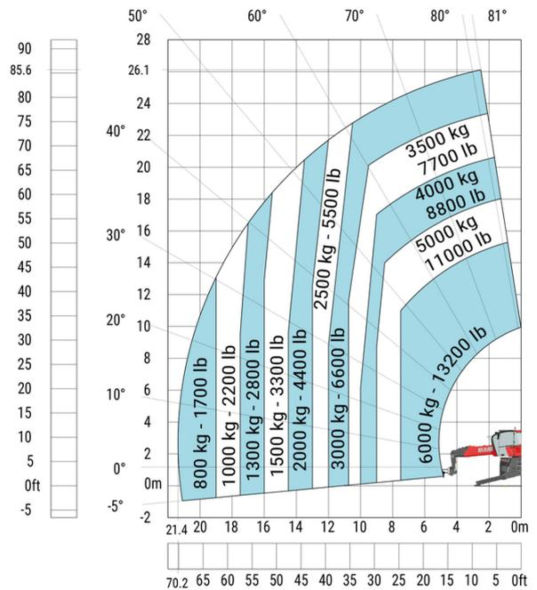
Drehung an abgesenkten Stützen mit 365 kg Arbeitskorb
