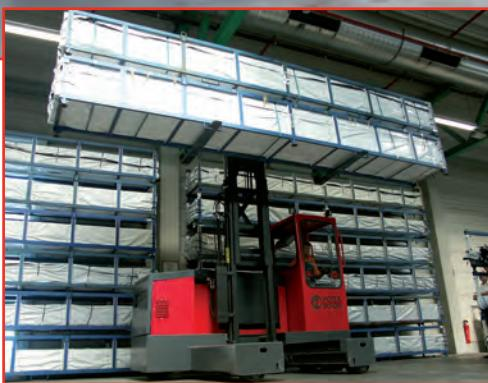
Die Platz einsparungen im Vergleich zum Gabelstapler und standardmäßigen Seitenstaplern sind in einem Beispiel angezeigt. Die Einsparungen kommen insbesondere bei dem Transport von Sperrigem und Langmaterial zur Entfaltung.
