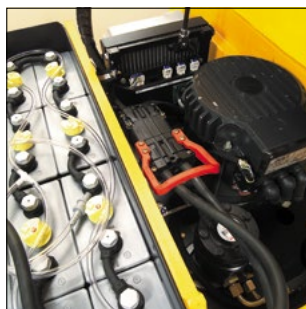
Moteur de traction et moteur de levée en technologie à courant triphasé
