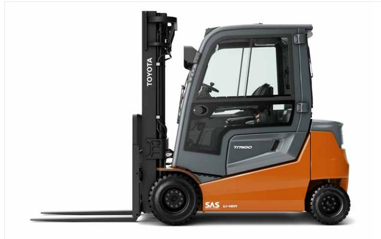
Die schwingend gelagerte Kabine schützt den Fahrer vor Vibrationen und Lärm und sorgt so für mehr Komfort und Produktivität.
