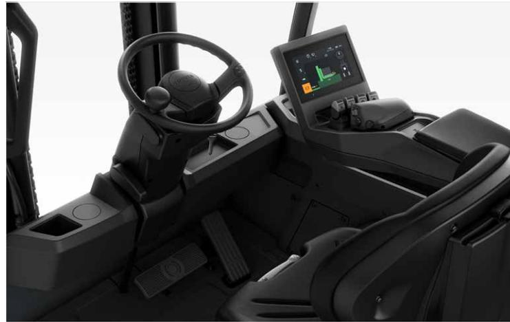
Ergonomische Fahrerkabine mit neuer Armlehne und Handballenauflage für optimalen Fahrerkomfort.
