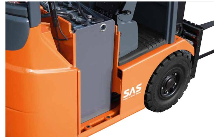
Serienmäßig niedriger Batteriewechsel. Optional: integriertes Rollenbett für schnellen Batteriewechsel.
