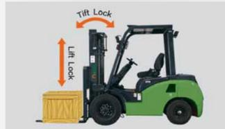
Sicherungsverriegelung für Hubmast
