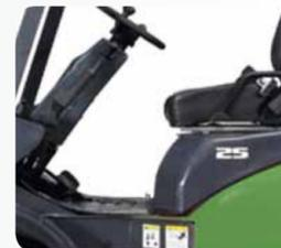
Der großzügige Arbeitsplatz bietet dem Fahrer reichlich Komfort; er erleichtert außerdem das Ein- und Aussteigen. Der voluminöse Fußraum lässt 30% mehr Bewegungsfreiheit als beim Vorgängermodell zu. Die Pedale sind ergonomisch gestaltet.
