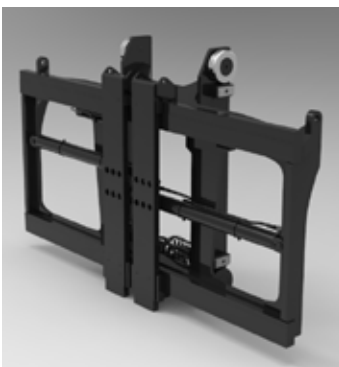
Doppelfunktionsgabelträger mit Seitenschub und Gabelzinkenverstellung.
