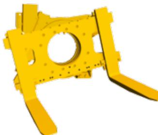
Das hydraulische Drehgerät wird zum seitlichen Entleeren von Behältern in allen Industriezweigen eingesetzt. Der hochwertige Antrieb über Schneckenwelle und Schneckenrad gehört weltweit zu den bevorzugten Ausstattungen in Gießereien und der gesamten Metallindustrie.
