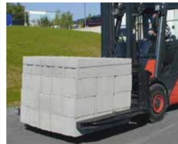
In der Baustoffindustrie werden neben Stein- und Betonprodukten, welche auch unpalettiert verladen werden können, Sackwaren und lose Güter wie Sand und Kies bewegt. Für diese Waren kommen je nach Beschaffenheit spezielle Anbaugeräte zum Einsatz. Steinklammergeräte, Mehrfachpaletten-gabeln, Mehrfachseitenschieber, Abschieber, Palettenwendegeräte und Schaufeln erlauben das Handling dieser Materialien.
