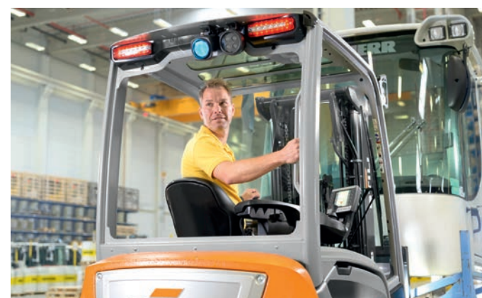
Schwenksitz Haltegriff mit optionaler Hupenbetätigung für ergonomisches Rückwärtsfahren
