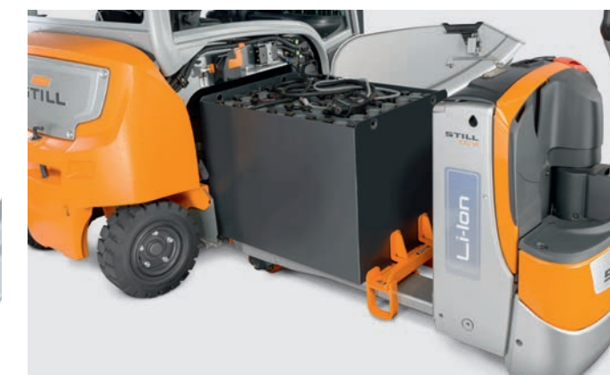
Batteriewechsel mit Elektrohubwagen
