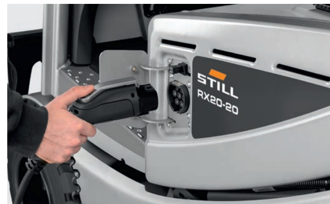
Optionaler Onboard Charger für dezentrales Laden ohne Batteriewechsel
