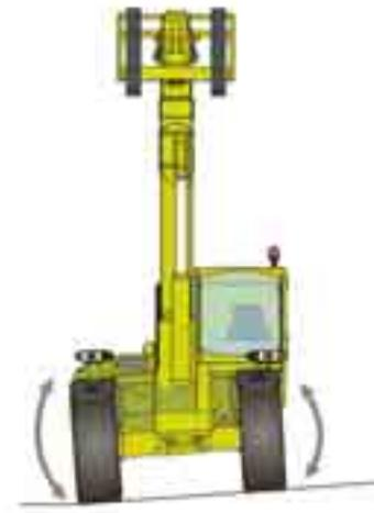
Die neuen Achsen mit Planeten-Untersetzungstriebwerke stammen ausschließlich aus der Planung und Herstellung von Merlo.
