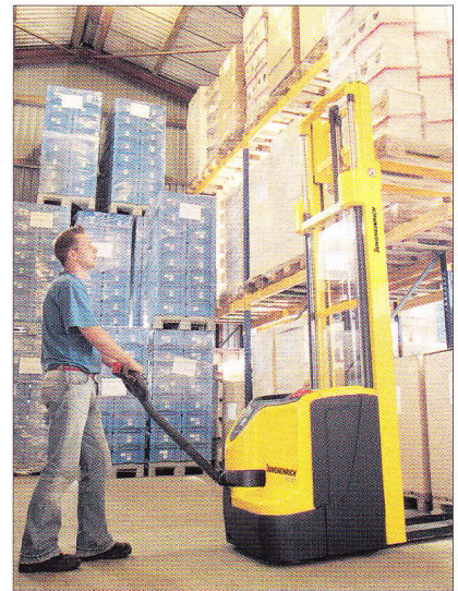
Optimale Sichtverhältnisse durch schlankes Hubgerüst
